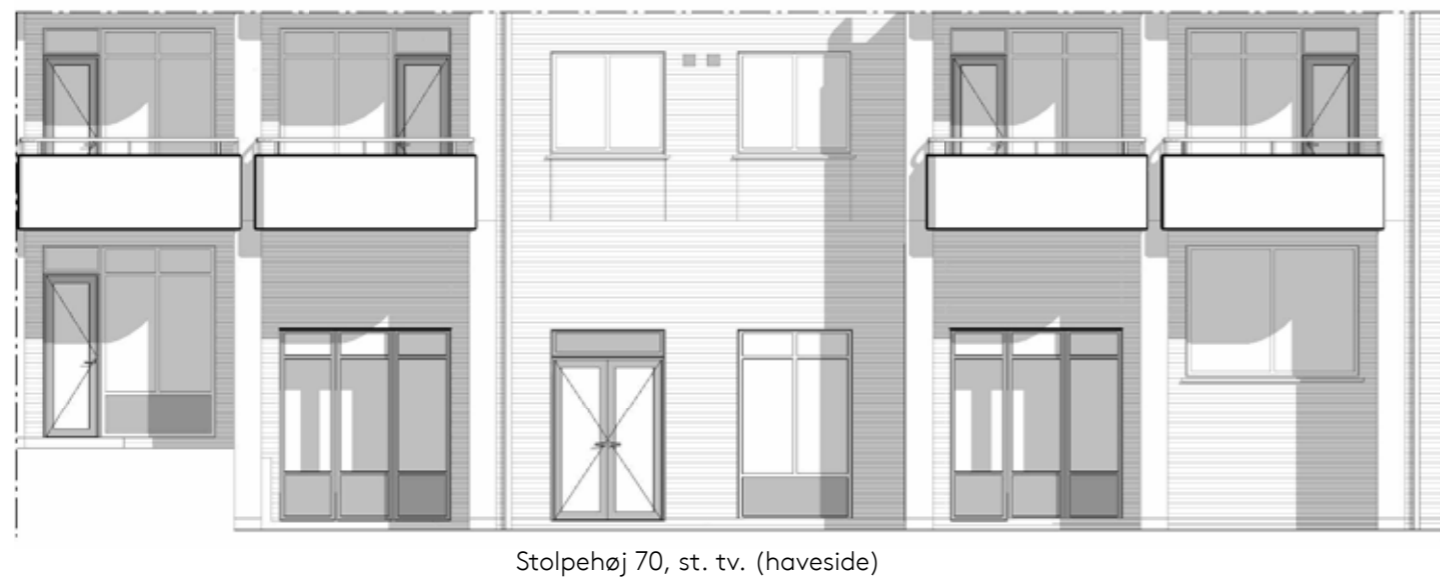
Opstalt af Stolpehøj 70, st. tv. til gårdside med nye vinduespartier og terrassedør til privat have Fremtidige forhold, 1:100
